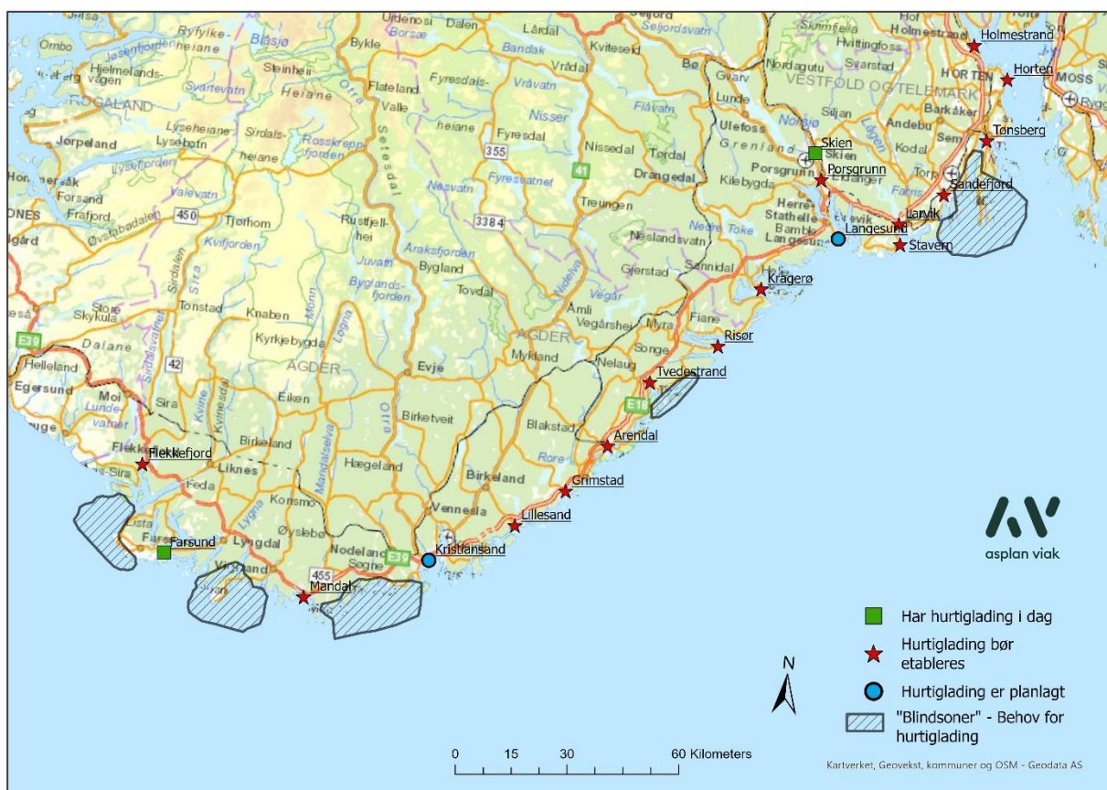
Figur 3-4: "Blindsoner" langs Agderkysten og Oslofjorden. Dette er områder der det må etableres hurtigladepunkt for å få et sammenhengende nettverk av hurtigladere, forutsatt 35 km rekkevidde på båtene og at alle byene etablerer hurtiglader i sentrum (evt har allerede etablert eller planlagt dette).
